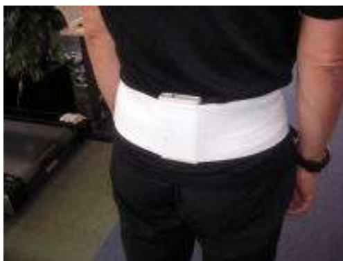
橋本研(理工学部電気電子情報通信工学科)で開発されたジャイロセンサーとその装着状態
